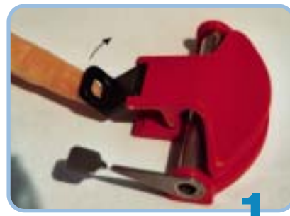
1 Sganciate la leva di bloccaggio nera e spingetela verso il basso.
