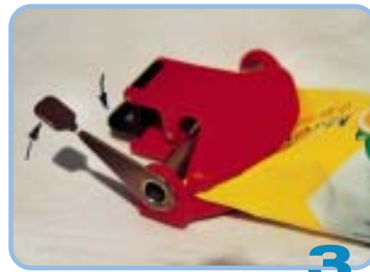
3 Fissate la leva di bloccaggio nera e giratela in senso orario...
