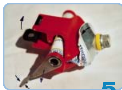
5 Una volta che il tubetto d'alluminio sarà vuoto, aprite la leva di bloccaggio nera e...
