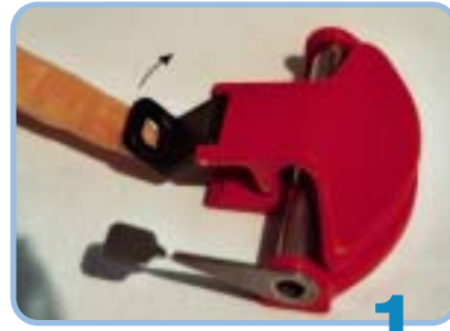
1 Schwarzen Spannhebel von unten herausdrücken.
